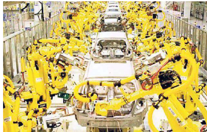
Una linea di produzione completamente robotizzata
