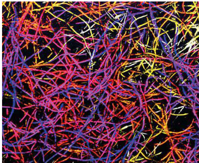
La spugna tridimensionale fatta di nanotubi di carbonio
