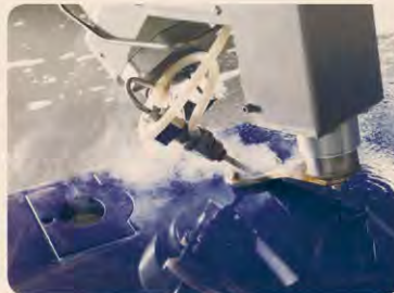
Esecuzione di taglio con getto d'acqua Primus 322
