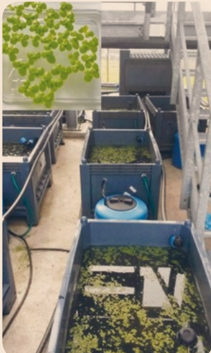
Impianto pilota per la valutazione in campo dei genotipi di Lemnaceae selezionati
