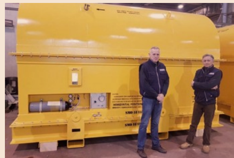
Flli Bertoni. Contenitore pressurizzato con azoto per trasporto e stoccaggio di macchine ad alto valore aggiunto
