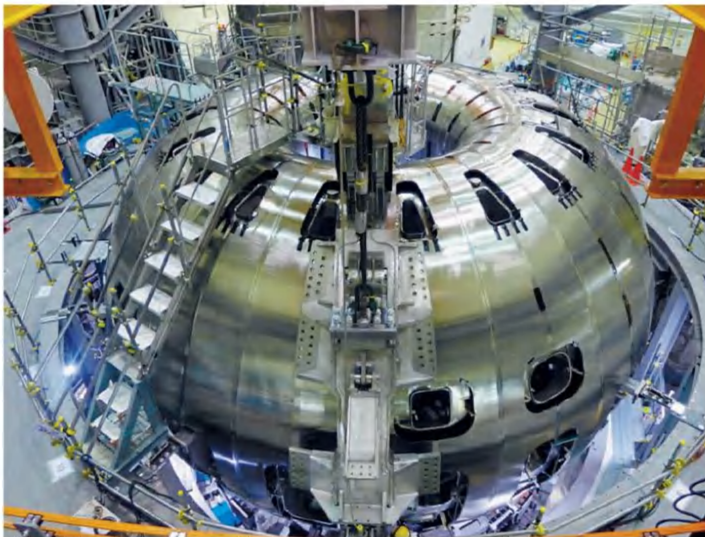
TEST SPERIMENTALE Il cuore del reattore Jt-60sa in via di assemblaggio a Naka, a 100 chilometri da Tokyo
