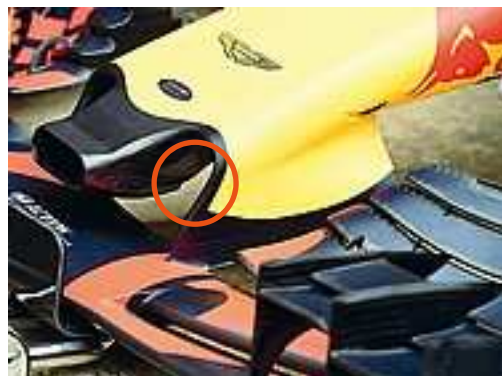
In alto le 2 alette Mercedes; sotto il punto dove esce l'aria che entra dal muso Red Bull AP COLOMBO
