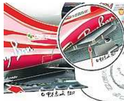
Il fondo senza intercapedine (freccia grande), diverso da quello tradizionale (freccia piccola)
