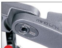
**1** - Tradizionale lo schema geometrico, che ricalca le altre full di Trek, con lo snodo tra i foderi ABP coassiale al mozzo, ammortizzatore flottante e sistema Mino Link per cambiare la geometria del telaio.
