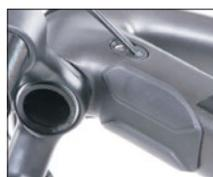
**3** - Calotta superiore dello sterzo, distanziali e attacco manubrio sono specifici per il nuovo sistema di blocco dello sterzo denominato Knock Block.
