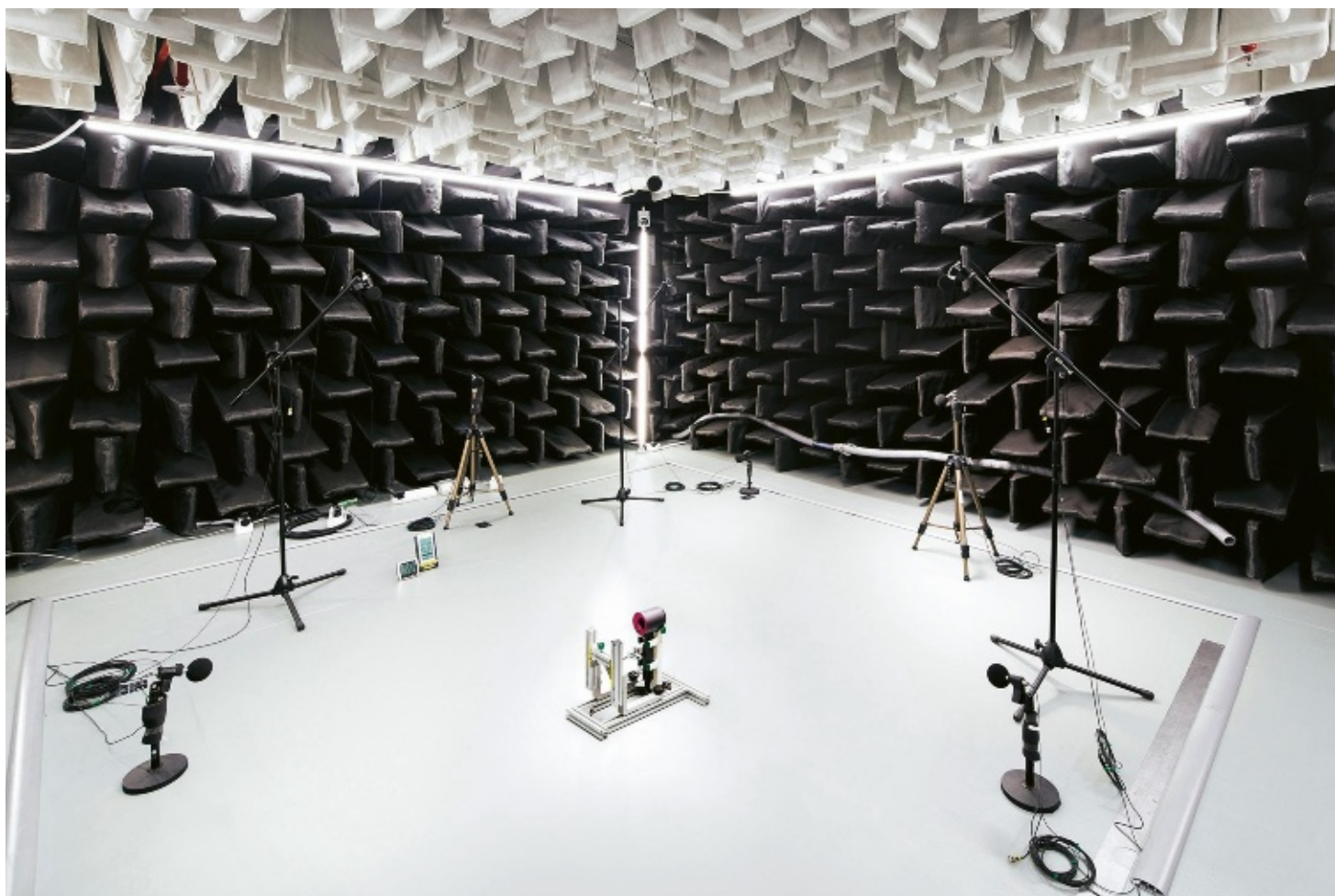
Il nuovo Technology centre di Dyson a Singapore ospita dieci laboratori all'avanguardia. Nell'immagine, la camera acustica dove si svolgono i test di rumorosità dei prodotti.
