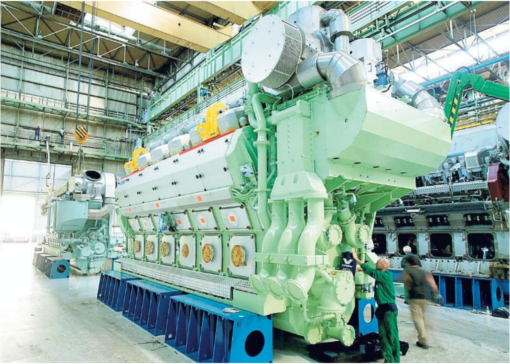
Fase di assemblaggio di un motore prodotto dalla Wartsila
